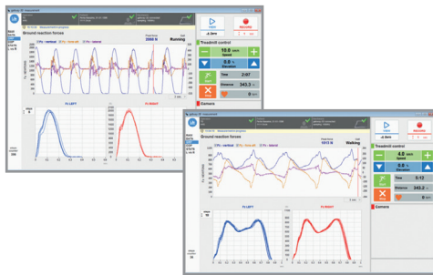
运用gaitway® 3d 在跑步过程中（左）和步行过程中（右）的三分力测量， F_z, F_y, F_x
