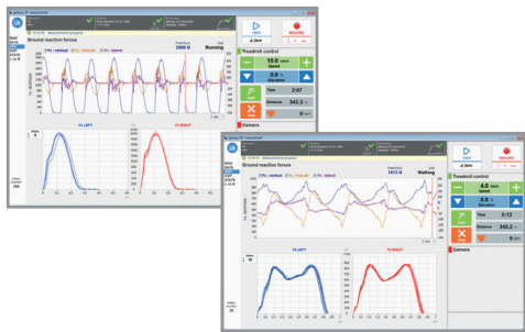
ゲイトウェイ3dトレッドミルでの3コンポーネント計測, F_z, F_y, F_x ランニング中(左) 歩行中(右)
